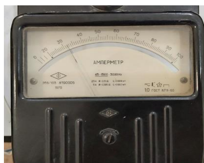
Рисунок 7 – Показания амперметра при коротком замыкании 1 витка
