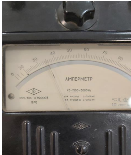
Рисунок 9 – Показания амперметра при коротком замыкании 5 витков
