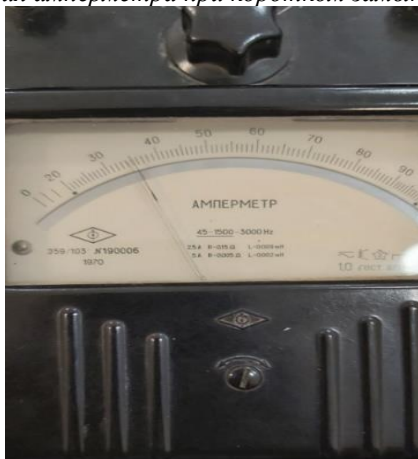
Рисунок 8 – Показания амперметра при коротком замыкании 3 витков
